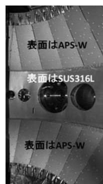
図1 真空容器内部から見た設置直後の高温壁。
