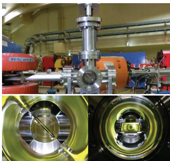
図6 YAG スクリーン 左：横から 右：下から
