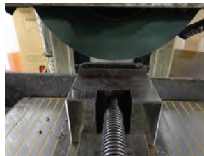
図 9 高さ方向の研削
