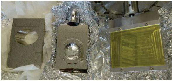
図7 左：内視鏡ミラー 中：YAG スクリーンホルダー 右：YAG スクリーン
