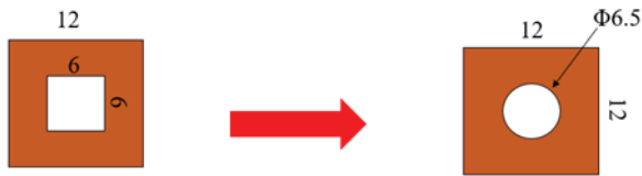
図 4 ホロコン断面(左：旧コイル、右：新コイル)
