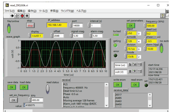
図8 (a) 400kHzに同期させた様子
