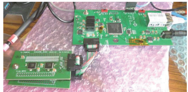
図 7. MPPC 電圧制御回路
