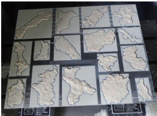
図 8 外周輪郭加工後 16 県 縦 400mm 横 500mm
