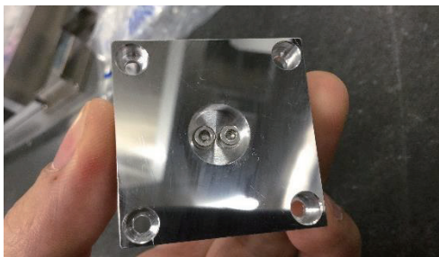
図 6. ねじ止めに起因する加工面のうねり (Waviness \approx 0.75 \mu\text{m} )
