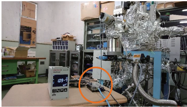
図 6. シリアルデバイスサーバ(シリアルデバイスサーバソフトの入った PC※オレンジ枠)
