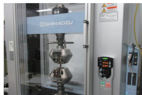
図 3. 引張強さの測定に用いた引張試験機外観
