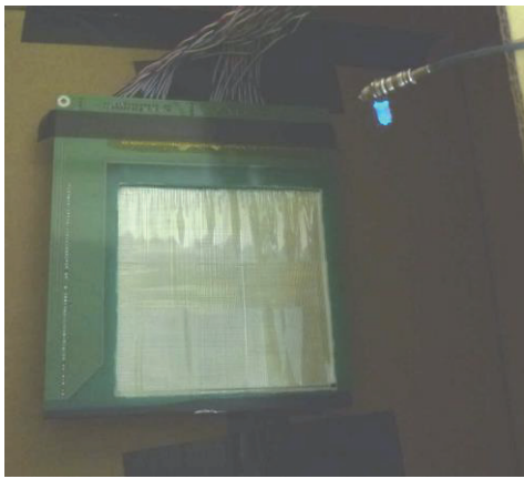
図 13. 暗箱内の検出面とテスト用 LED
