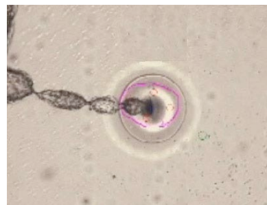
図 10. IR レーザーを強めの出力値を用いて吸着させた様子
