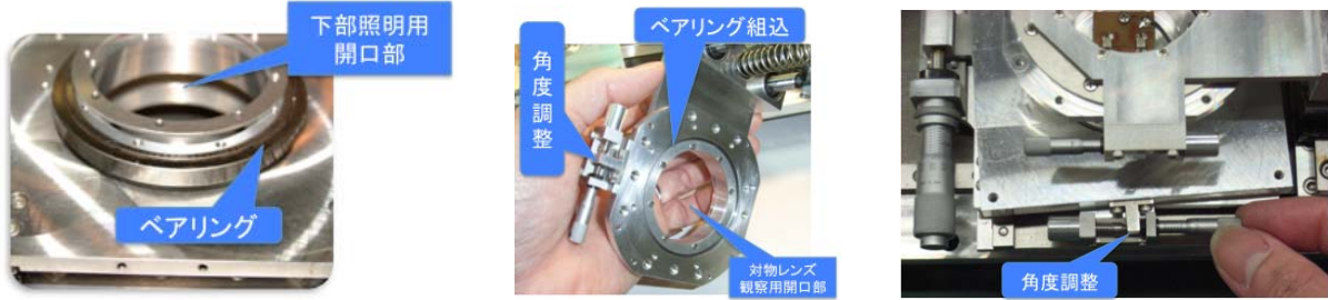
図 8 超薄型ベアリング使用例
