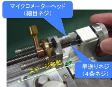
図 12 X 軸移動機構
