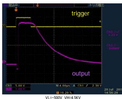
図5.2段式高電圧可変パルス発生回路の外観とパルス出力波形
