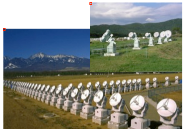
(b) 太陽電波観測所/ 太陽ヘリオグラフと太陽強度偏波計
