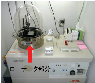
図4 ローテータを装着した真空蒸着装置(左)とその回転部に装填したグリッドホルダー(右)
