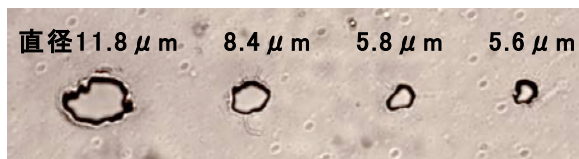
図 6. UV レーザーのフォーカス調整
