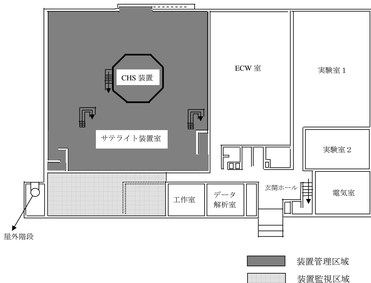
図 1 - 3 - 4 開発実験棟の装置管理区域と装置監視区域(2007 年度末現在)
