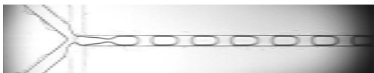
図 9. マイクロチャンネル装置でアルギン酸カルシウム微粒子が生成される
