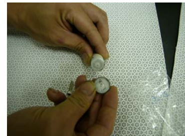
図 5 破損した stand-off Standoff はセラミックシャフトの両端に金属製の留め具が付いている。その部分が折れた。
