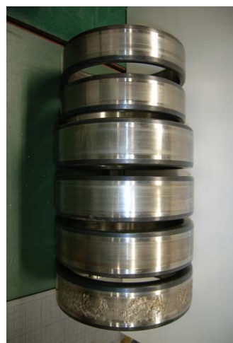
図3. 損傷したアクロスの軸受（最下部の軸受が大きく損傷）
