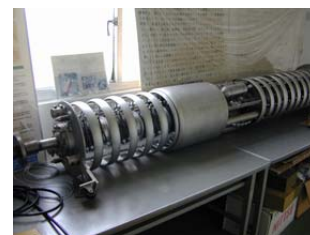
図3 展示されている加速器の内部 兵庫県西部地震により崩壊した 5SDH 加速器の内部構造体（加速器本体）。
