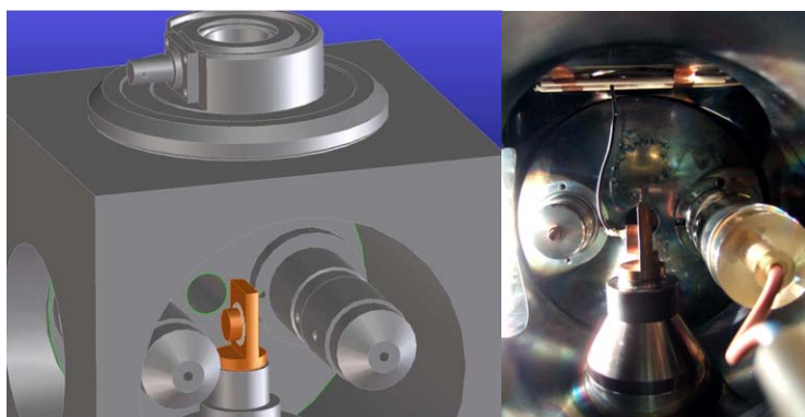
図 9. イオンミル内に設置されたファラデーカップ
