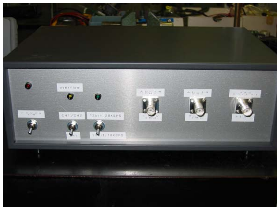
図5.ビーム電流補正装置の外観
