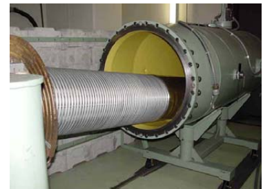
図 9 崩壊した加速器 加速器タンクを開けた時の状態。加速器本体を支える絶縁コラムの接着面が破断し、ポッキリ折れた状態でターミナルシェルが加速器タンクに接触している。
