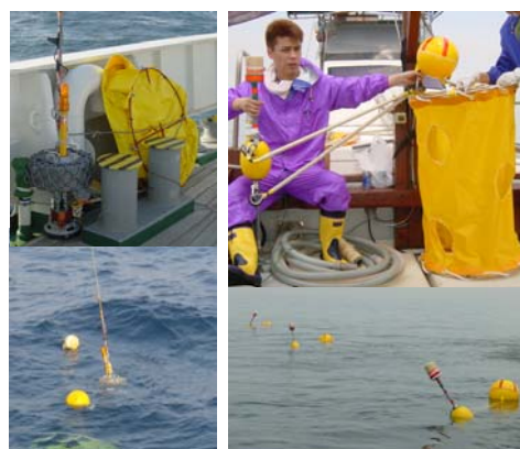
図 2. 既製品漂流ブイ（左）と新規開発した GPS ケータイ型漂流ブイ（右）
