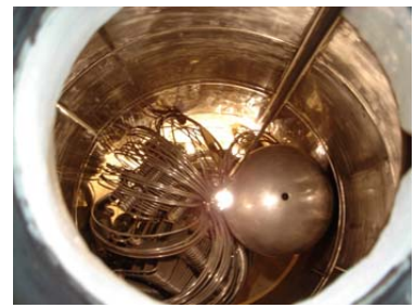
図 7 地震で崩壊したシングルエンド型静電加速器 加速器タンク上部よりの写真。ちょうど蛸が潰れたような姿だが、頭に見える部分がターミナルシェル、足に見える部分がバラバラになったフープ。
