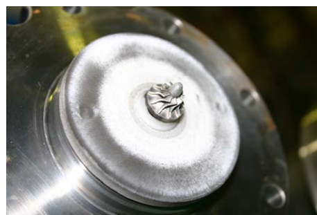
図 3 : 2 号機 T1(低温側)損傷
