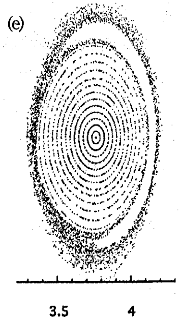
図 3.4-2 トーラス内側 ( Z=0, 3.25 < R < 3.45 m) から出発して、ダイバータ板に達するまでの磁力線の距離をプロットする。 (a) 磁気軸 ( R_{ax} ) = 3.75 m の場合、 (b) R_{ax} = 3.85 m の場合、 (c) (b) の配位に m/n = 1/1 の磁気島を加えた場合で出発点が磁気島の 0 点近くの時、 (d) (c) と同じ配位で、出発点が磁気島の X 点の近くにある場合、 (e) (d) の出発点が存在するポロイダル面内に磁力線の貫通点分布。
