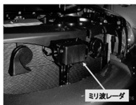
車両搭載状態のミリ波レーダー
