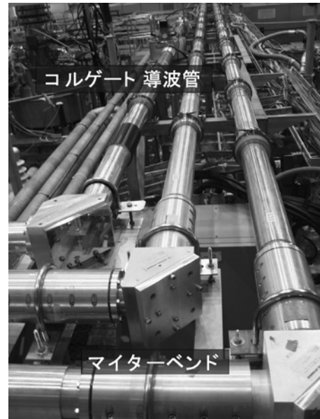
Fig. 11 内径88.9 mmのコルゲート導波管列。
