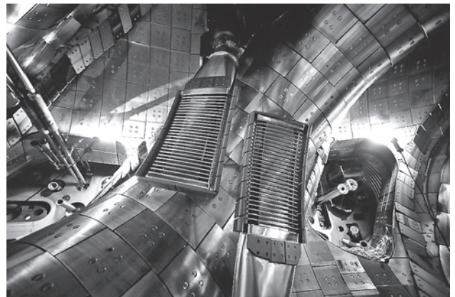
図16 改良された ICH アンテナ。ダブルストラップにより、トロイダル波数を制御することができる。
