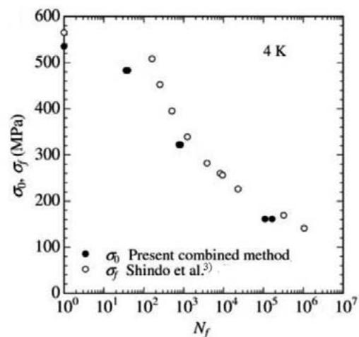
Fig. 2.  $S-N$  diagrams at 4 K.
