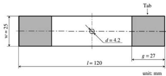
Fig. 1. Open hole specimen.
